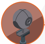
Camera PTZ câblée en 3G SDI pour filmer le présentateur.
